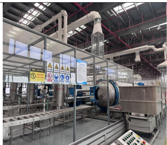
高温蒸煮车间蒸煮设备、进料废气收集系统
